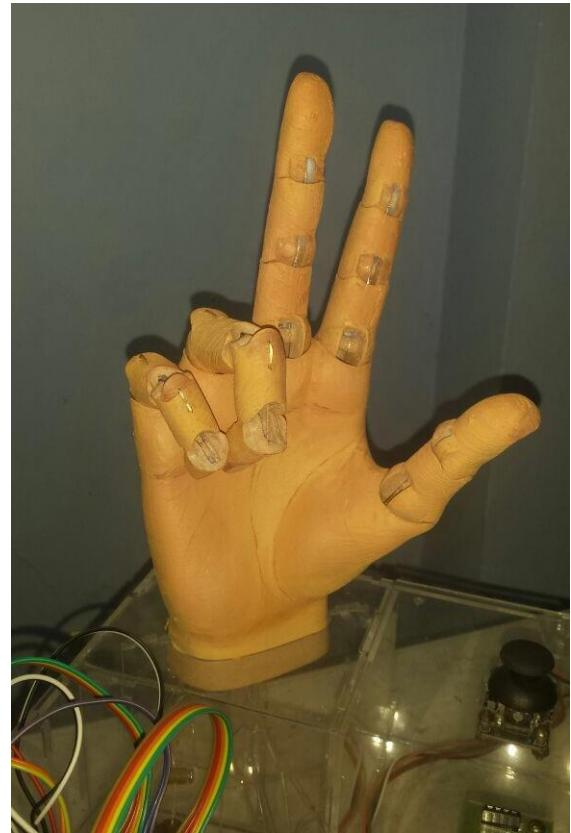
Fig. 5. Pruebas de Funcionalidad de Mano Robótica.
