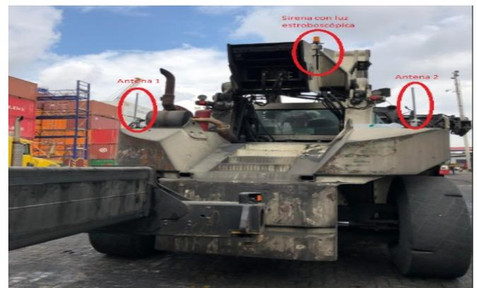
Fig 3. Colocación de antenas de 2.45 GHz en una excavadora.
