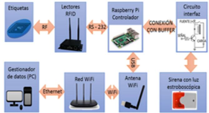
Fig 2. Diagrama de Bloques del Sistema de Prevención de accidentes para maquinaria pesada.
