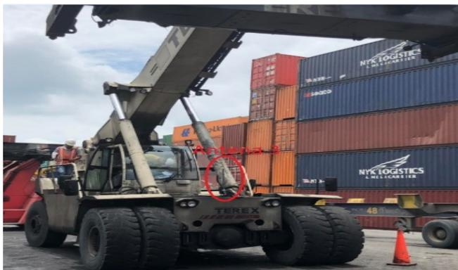
Fig 4. Ubicación de antena frontal en la grúa.
