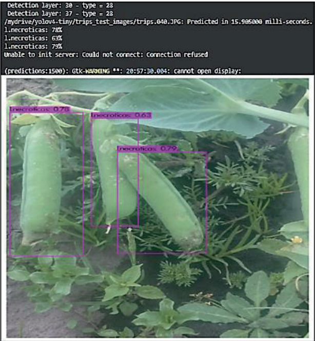
Fig.13. Reconocimiento de lesiones necróticas en el cultivo del guisante con el modelo yolov4-tiny
