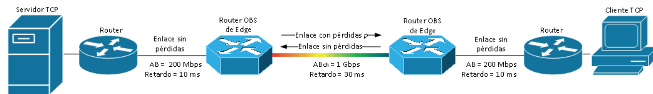
Fig. 3. Modelo básico para la evaluación de TCP Reno, NewReno y SACK
