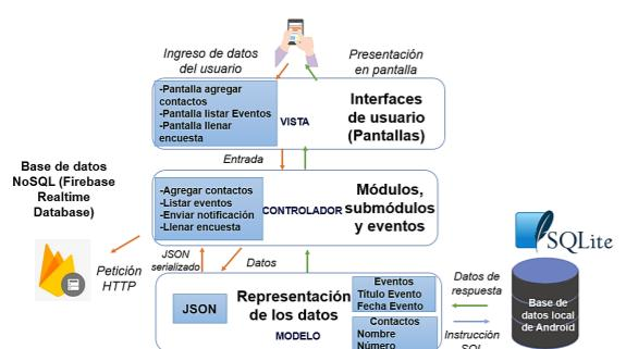
Fig.4 Modelo Vista Controlador de la aplicación móvil
