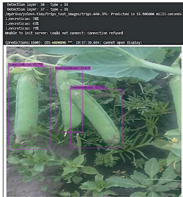
Fig.13. Reconocimiento de lesiones necróticas en el cultivo del guisante con el modelo yolov4-tiny
