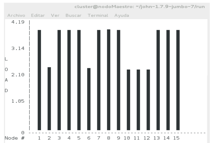
Fig 4. Balanceo de carga en el clúster al ejecutar MPICH+JTR
